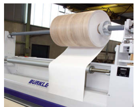
Abwickelstation über dem Kalandrier Uncoiling station above the calender
